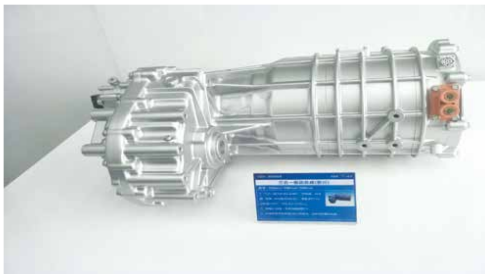
図3-5 「小螞蟻」の機電一体化駆動ユニット
